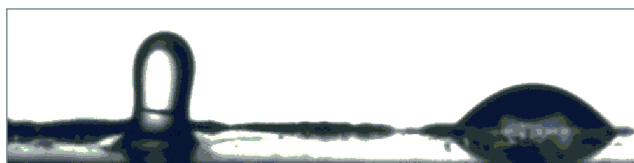
Fig. 8. Goutte de TBP en train de se détacher du film: par émulsification (à gauche) et par roll-up (à droite).
