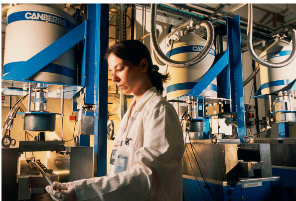
Fig. 107. Mesure de spectrométrie gamma sur les maquettes critiques ÉOLE/MINERVE. Insertion de crayons combustibles UO_2 ou MOX sous une diode germanium.
