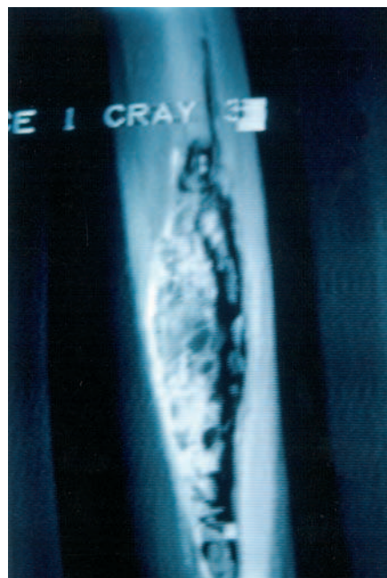
Fig. 21. Défaut d'étanchéité créé par hydruration.
