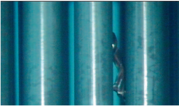
Fig. 20. Corps migrant bloqué entre deux rangées de crayons d'un assemblage REP.
