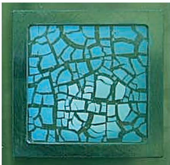
Fig. 99. Film de gel à la fin de la fracturation, observation des paillettes millimétriques.
