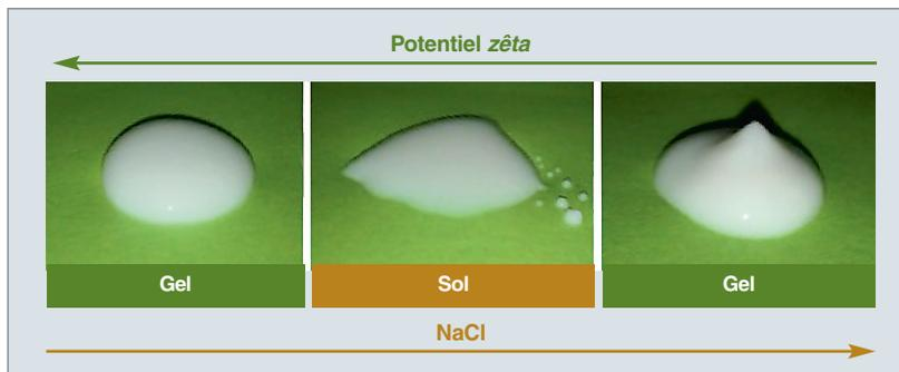
Fig. 101. Illustration de la transition gel/sol/gel sur une suspension d'alumine par ajout de quantités croissantes de NaCl.
