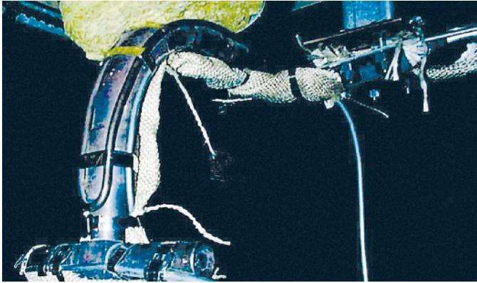
Fig. 97. Le système de détection de l'hydrogène sur PHÉNIX. L'hydrogène dissous dans le sodium est tiré au vide à travers une membrane de nickel et analysé par spectrométrie de masse.
