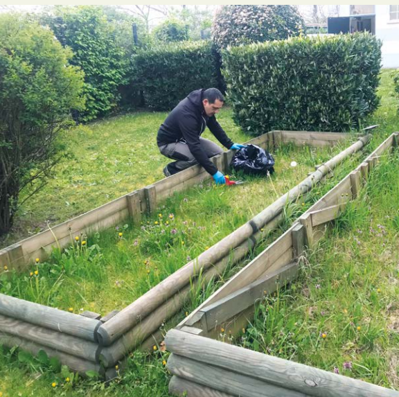
Prélèvement d'herbe pour mesure de la radioactivité en laboratoire.
