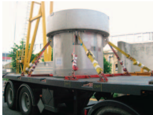
Emballage DGD permettant le transport de déchets du centre de Fontenay-aux-Roses vers celui de Cadarache. © CEA
