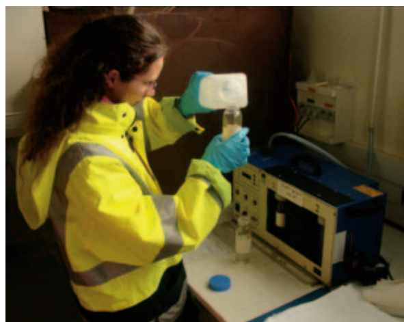
Prélèvement de l'eau du « barboteur tritium », dispositif servant à surveiller la concentration en tritium atmosphérique.
