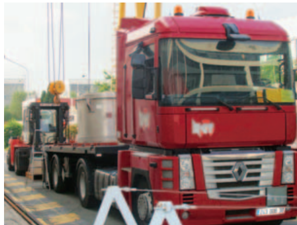
Emballage DGD permettant le transport de déchets du centre de Fontenay-aux-Roses vers celui de Cadarache. © CEA
