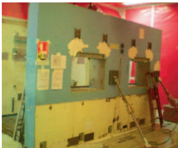
Panneaux avant de la chaîne blindée Pré-Antinéa. © CEA
